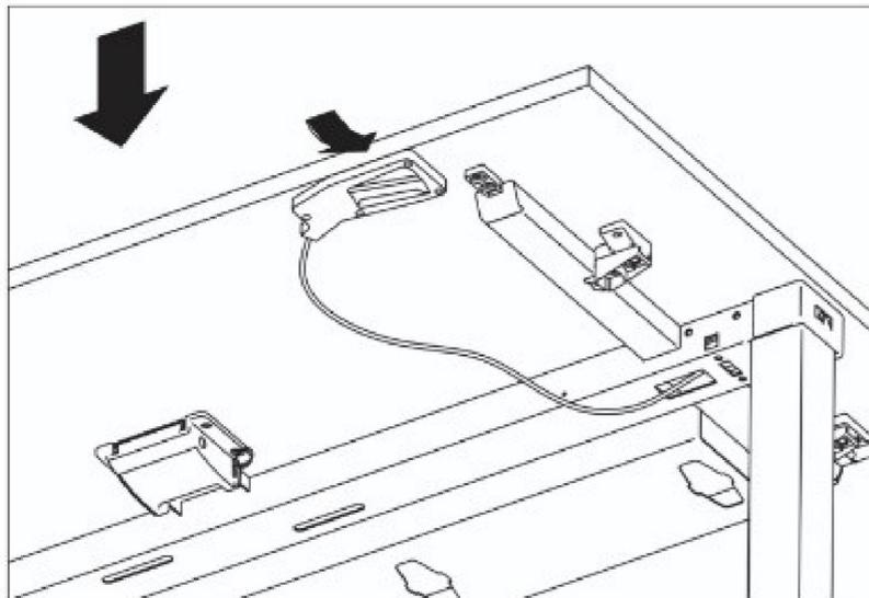
Um die Höhe des Tisches zu verstellen, wird eine Hand mit leichtem Druck auf die Tischplatte gelegt, mit der anderen Hand der Auslösegriff betätigt und der Tisch in die gewünschte Position gefahren.
